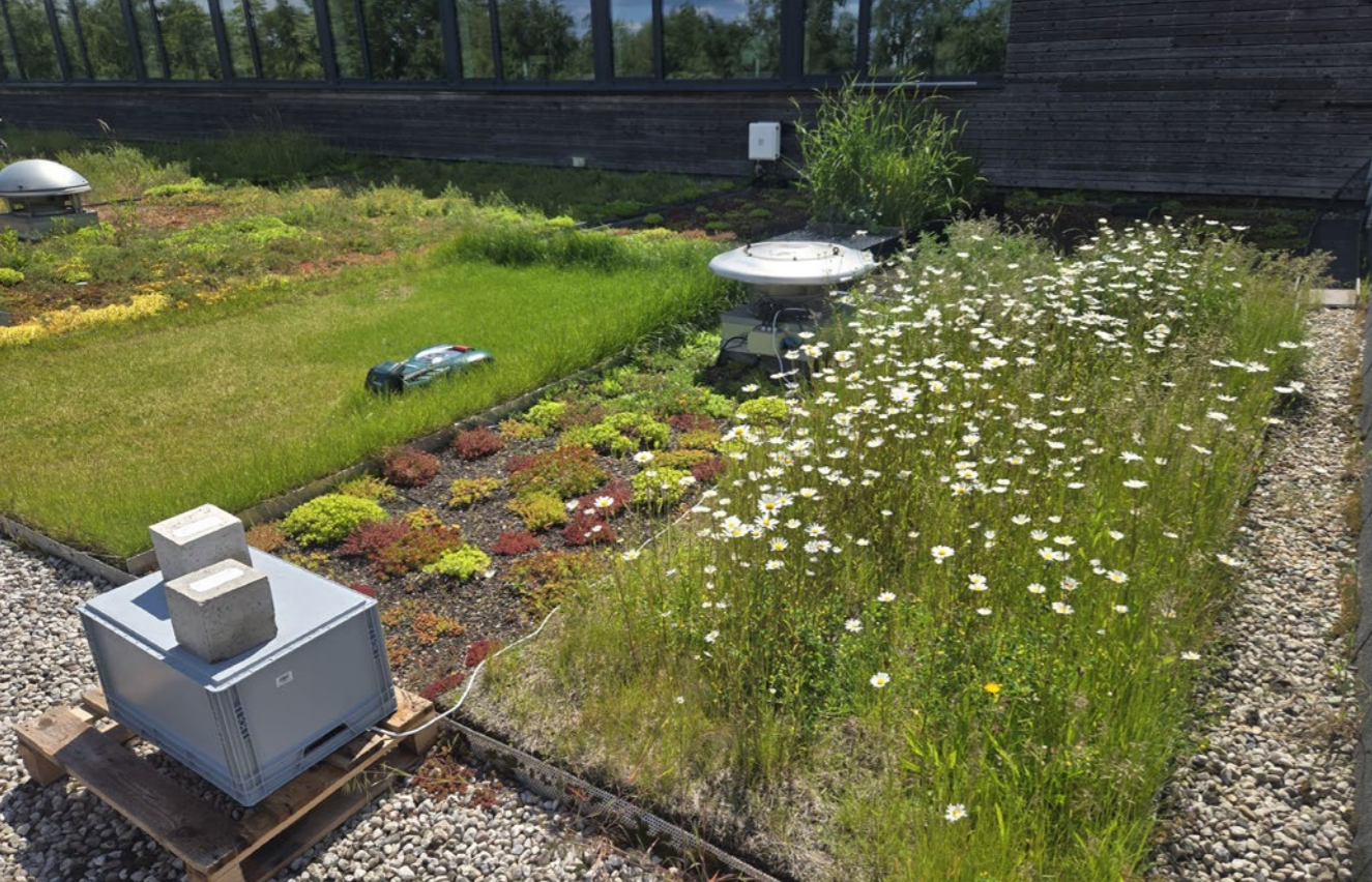
Experimentální plochy kombinují různé drenážní vrstvy, substráty a vegetaci
